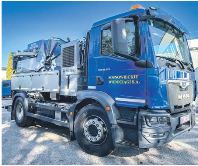
Nowy Kaiser jest wykorzystywany do czyszczenia i usuwania awarii w sieciach kanalizacyjnych.
